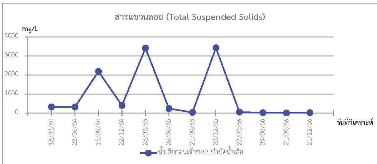
ภาพที่ 3.5.5-2 กราฟเปรียบเทียบผลการตรวจวิเคราะห์คุณภาพน้ำก่อนเข้าระบบบำบัดน้ำเสีย ในปี พ.ศ. 2564 ถึงปัจจุบัน
