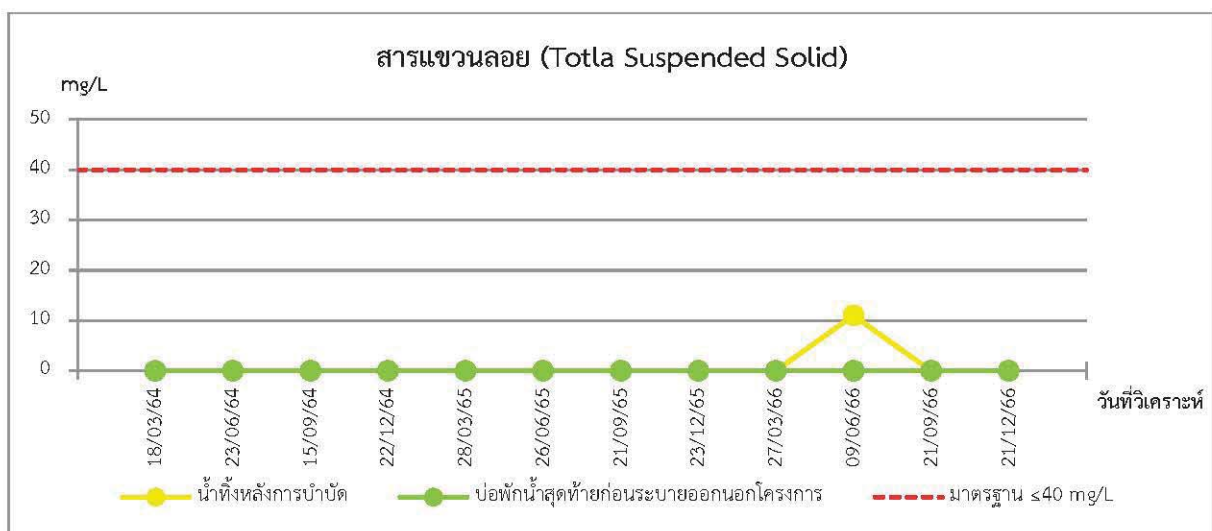
ภาพที่ 3.5.5-3 กราฟเปรียบเทียบผลการตรวจวิเคราะห์คุณภาพน้ำทิ้งหลังการบำบัด และบ่อกักน้ำสุดท้าย ในปี พ.ศ. 2564 ถึงปัจจุบัน
